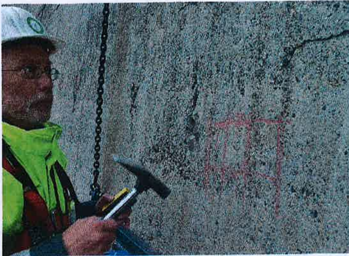
Abklopfen der Fassadenfläche, Markierung der Schadstellen und Überprüfung der Betonüberdeckung der Bewehrung
